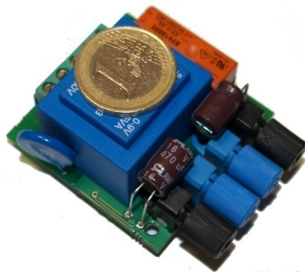
Figura 1: Relé Óptico (Optoswitch)
