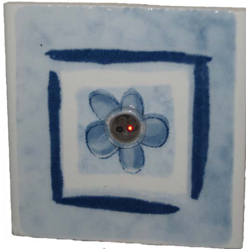
Figura 15: Colocación fibra óptica en cerámica
